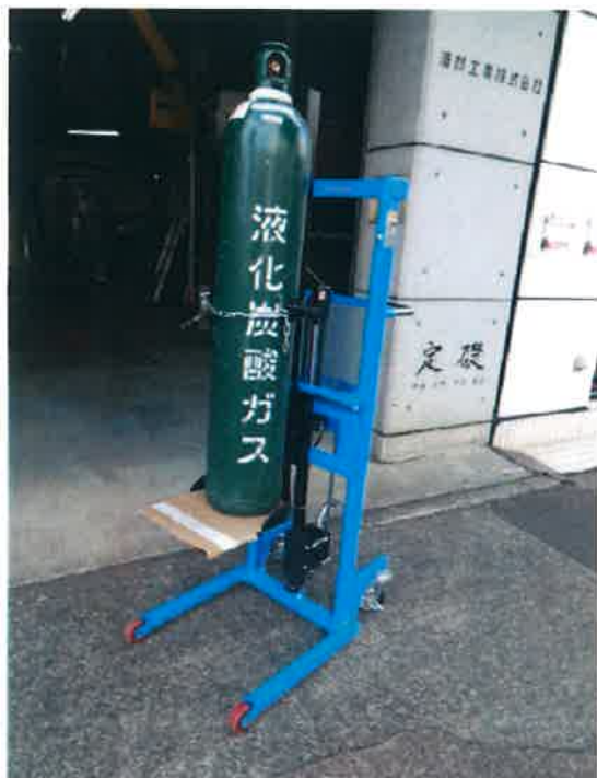
標準型:脚幅(外寸460mm内寸370mm)
