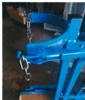
●ポンベ受け部
